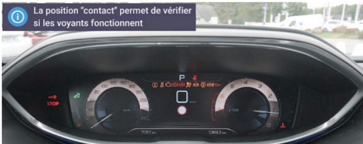
La position "contact" permet de vérifier le fonctionnement des témoins d'alerte :
