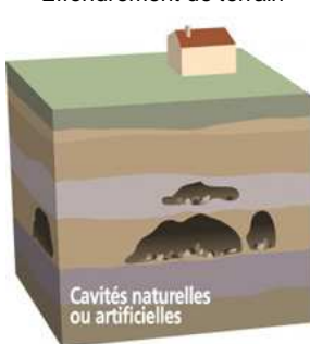
Effondrement de terrain
