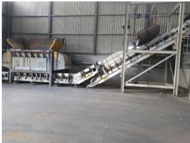
Figure 30 : Trémie et tapis de transfert des déchets dans le bâtiment B4
