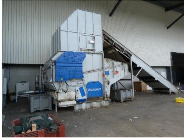
Figure 20 : Broyage primaire VECOPLAN des plastiques sous auvent du bâtiment B3
