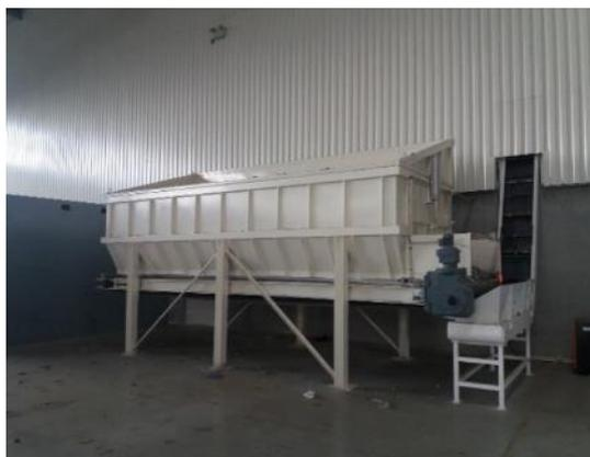
Figure 22 : Trémie de transfert des plastiques vers lignes de broyage/lavage
