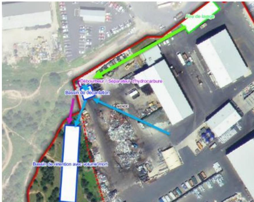
Figure 46 : Illustration du mode de gestion des eaux en partie Nord-Est
