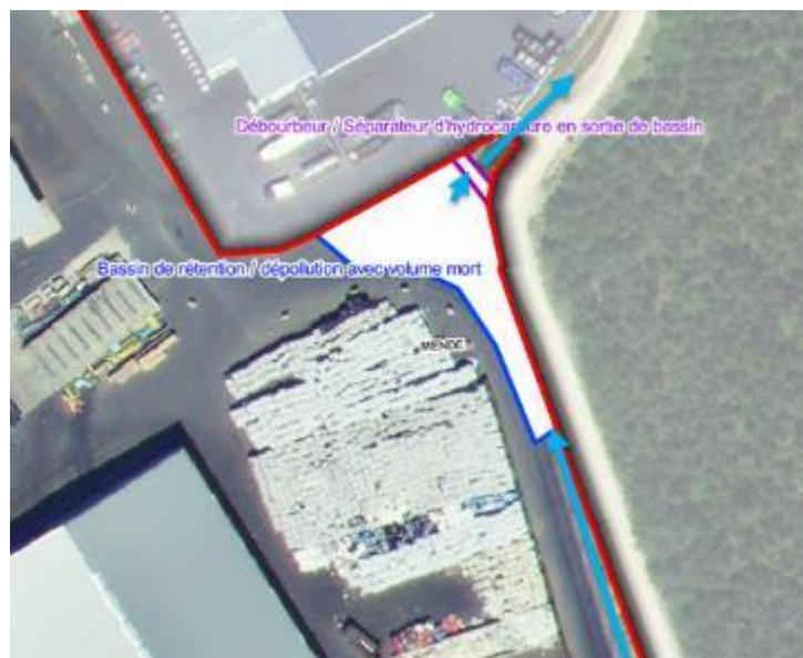
Figure 47 : Illustration du mode de gestion des eaux en partie Nord-Ouest
