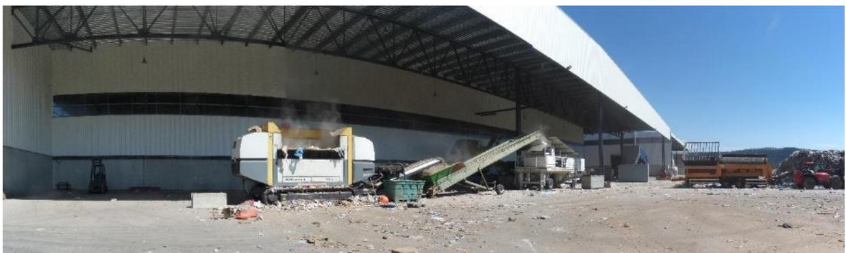
Figure 26 : Ligne de broyage DIB/encombrants sous auvent du bâtiment B3 bis
