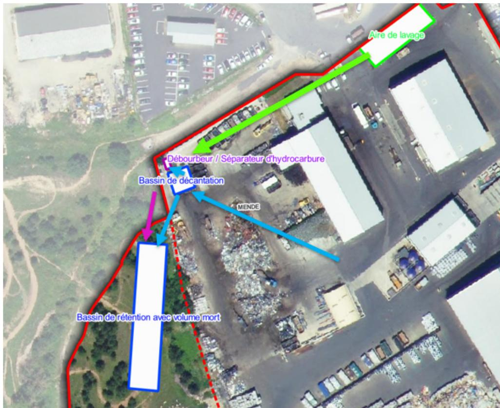
Figure 58: Principe de fonctionnement - BR1 projeté
