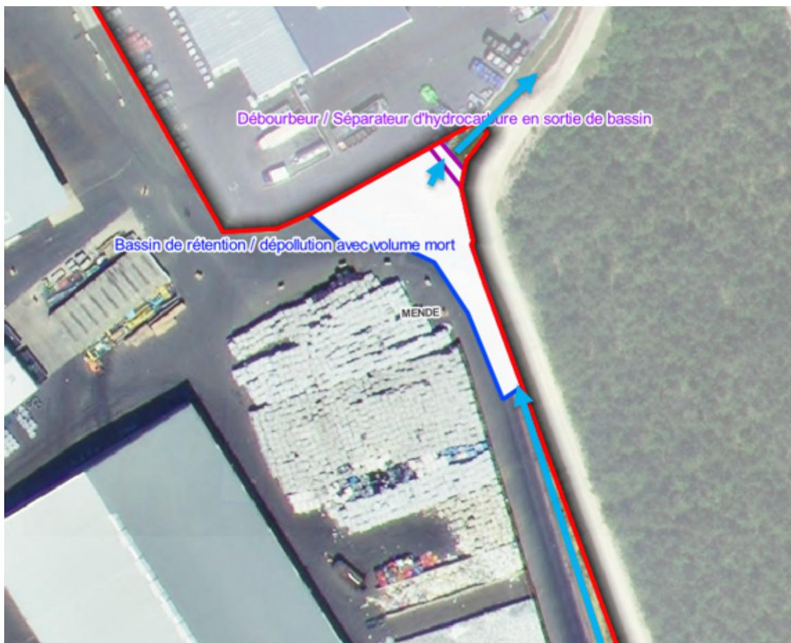
Figure 59: Principe de fonctionnement – BR3 projeté
