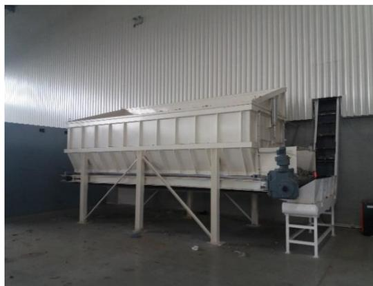
Figure 15 : Trémie de transfert des plastiques vers lignes de broyage/lavage
