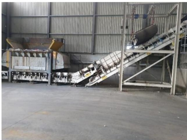
*Figure 23 : Trémie et tapis de transfert des déchets dans le bâtiment B4*
