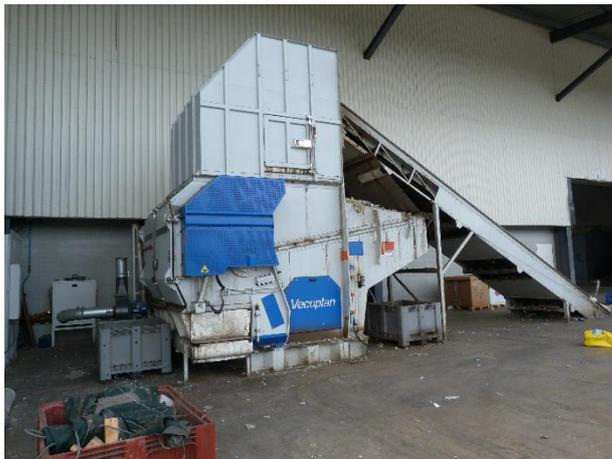
Figure 13 : Broyage primaire VECOPLAN des plastiques sous auvent du bâtiment B3
