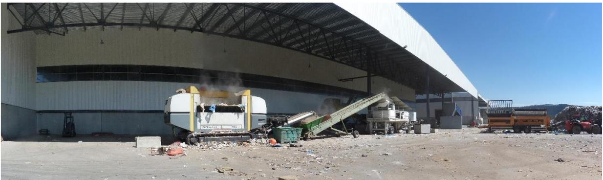
Figure 19 : Ligne de broyage DIB/encombrants sous auvent du bâtiment B3 bis
