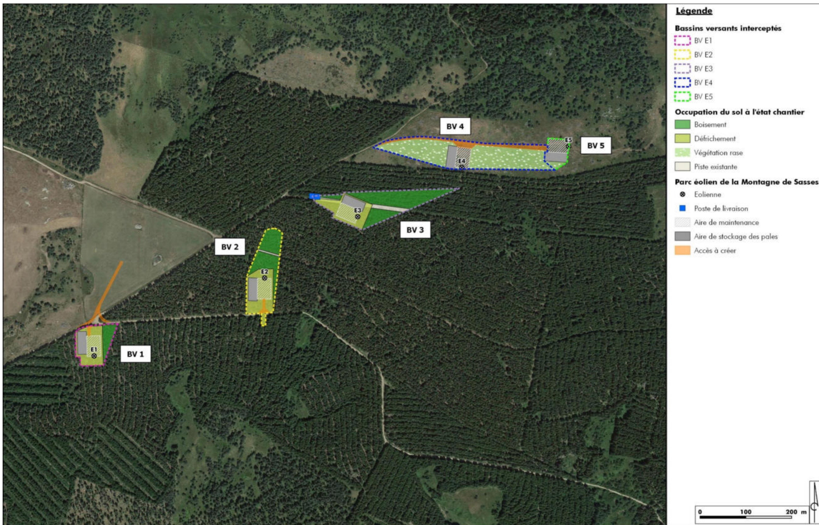
Illustration 48 : Occupation du sol des bassins versants interceptés à l'état chantier Source : Google Satellite, VSB ; Réalisation : Artifex, 2021
