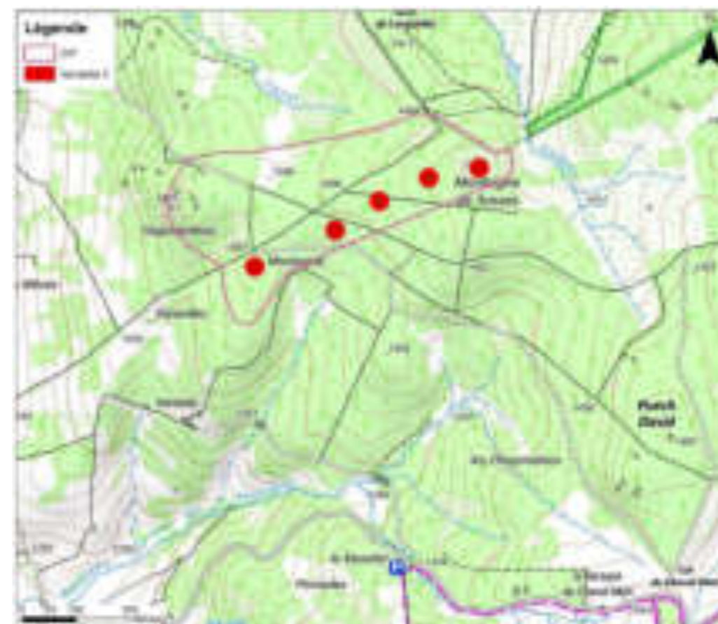
Implantation des éoliennes de la variante retenue
