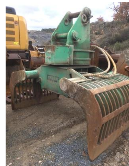
MR-T.7 : Enlèvement par soulèvement à la pince des divers matériaux entreposés
