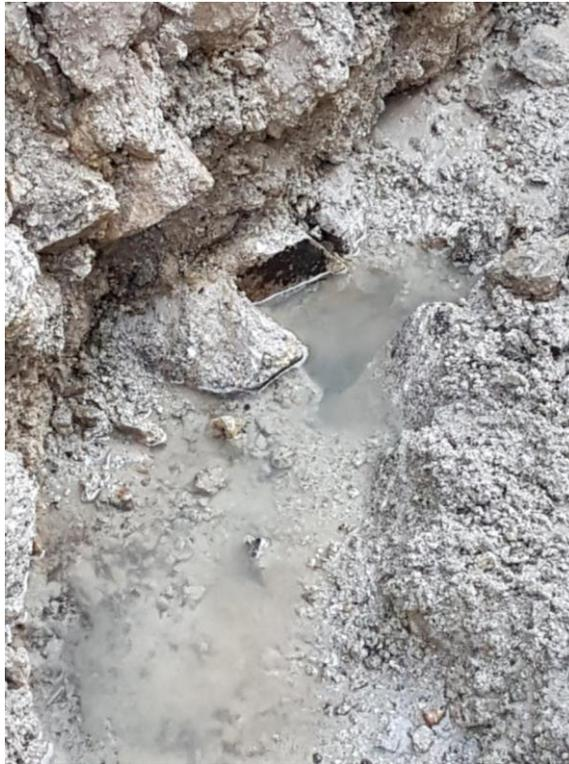
**Figure 4** : Granite porphyroïde altéré et fissuré au droit de l'arrivée d'eau principale mise en évidence par la tranchée de reconnaissance
