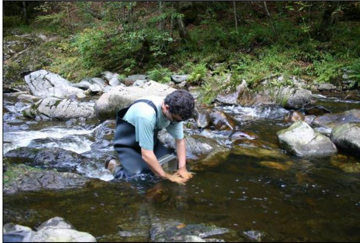
Photo 15 : Echantillonnage de la faune benthique à l'aide d'un filet « Surber »
