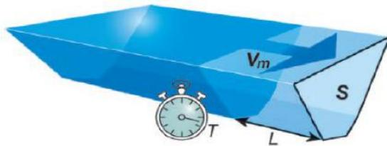
Figure 7 : Principe du jaugeage par exploration des vitesses (extrait de Onema, Cemagref, 2011, Guide technique pour le contrôle des débits réglementaires)
