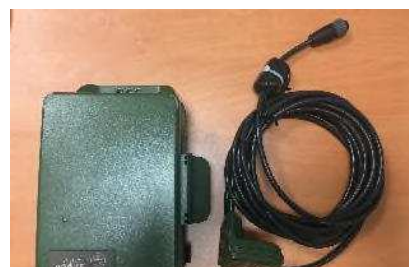
Illustration 62 : Enregistreur SM4Bat avec microphone U2
