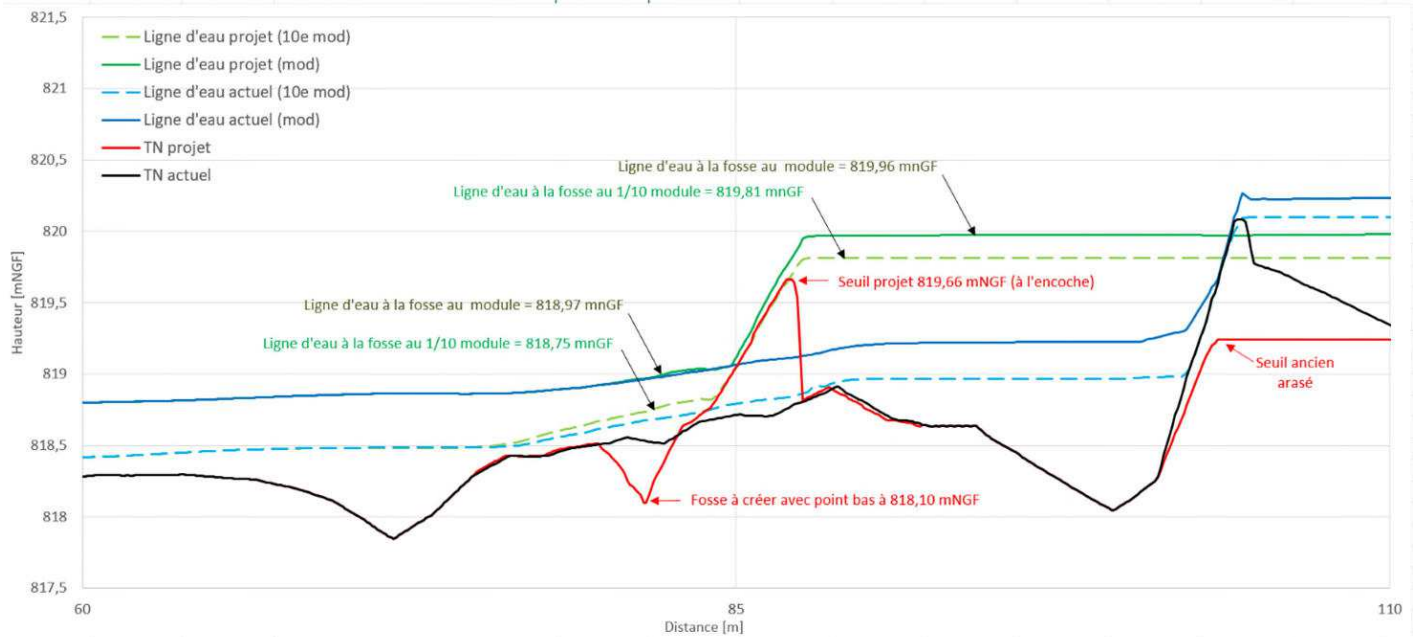
Illustration 108 : Profil en long des lignes d'eau et du fil d'eau en situation actuelle et en situation projet au niveau du nouveau seuil des « Valettes » (Source : Cereg)
