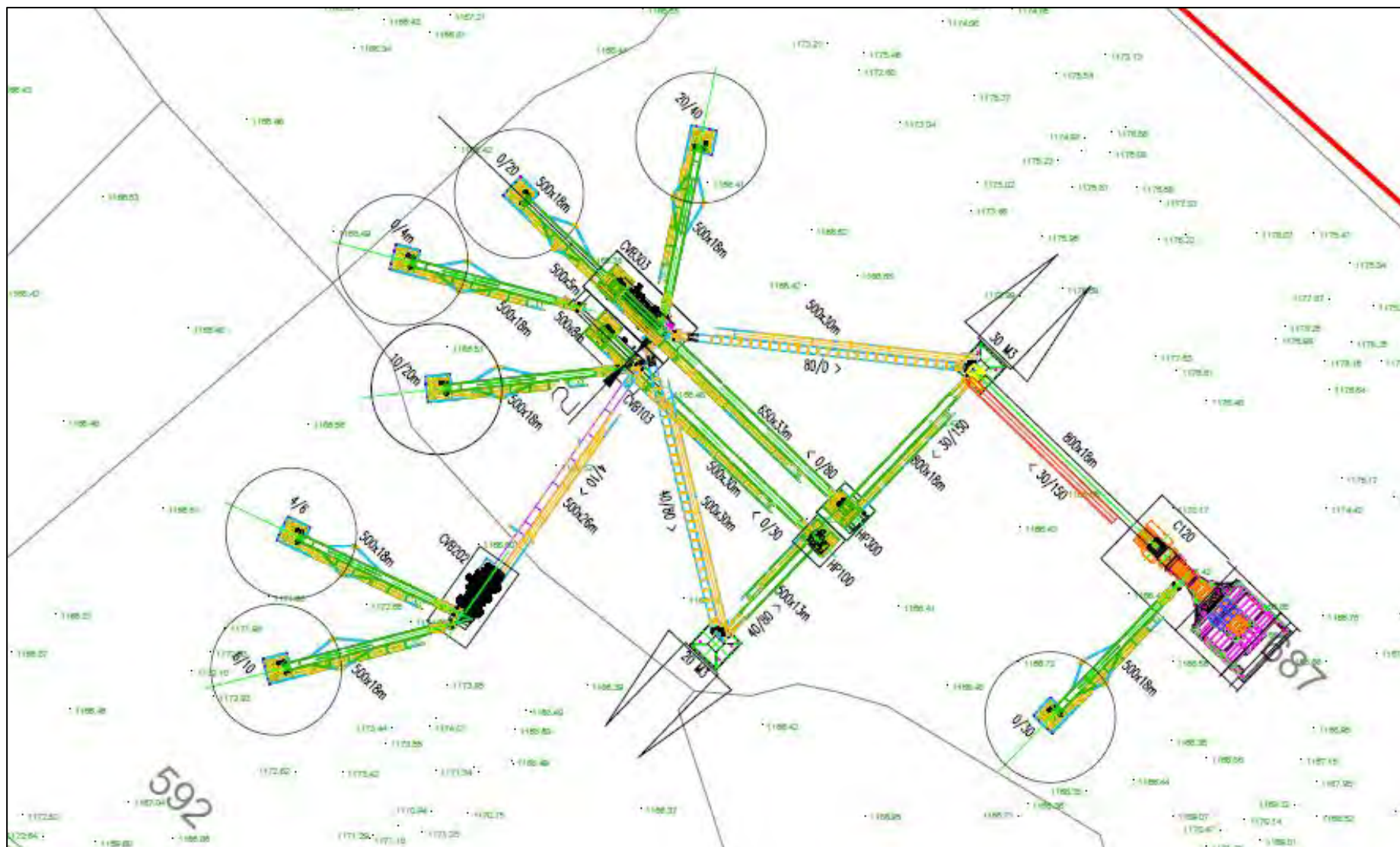
Figure 2 : Installations de traitements primaires et secondaires et tertiaires, SOMATRA, 2022
