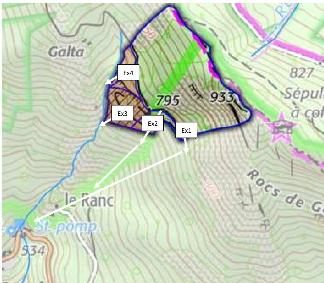
Illustration 5 : Exutoire des eaux de ruissellement
