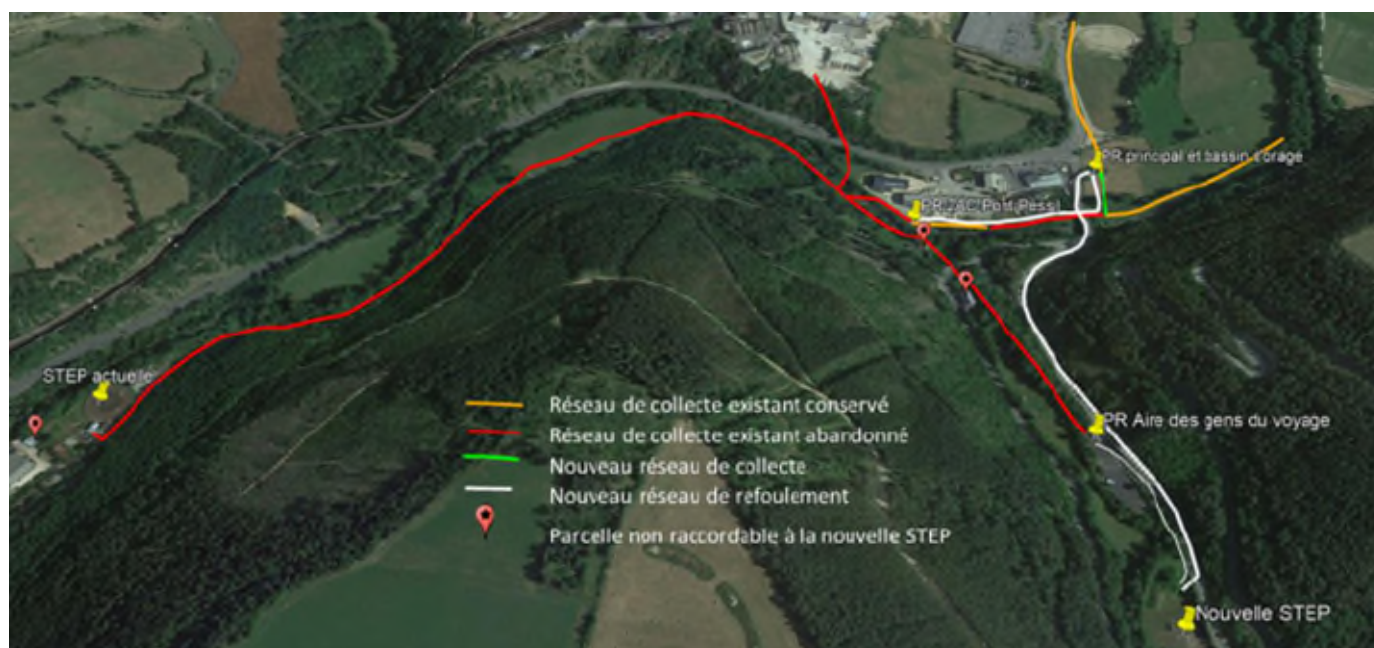
Illustration 8 : Antennes de réseaux abandonnés dans le cadre du projet (Source : CEREG, dossier PROJET de la nouvelle station de traitement des eaux usées de Marvejols, de Montrodat et d'Antrenas, Juin 2023)
