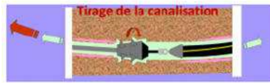
Illustration 17 : Forage dirigé – mise en place de la canalisation (source : CEREG, Août 2022)
