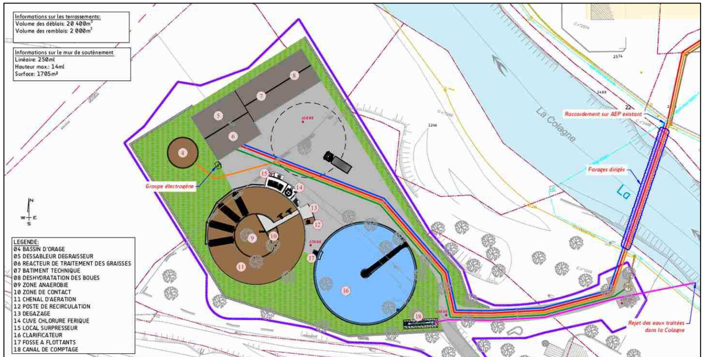
Illustration 1 : Nouvelle station de traitement des eaux usées
