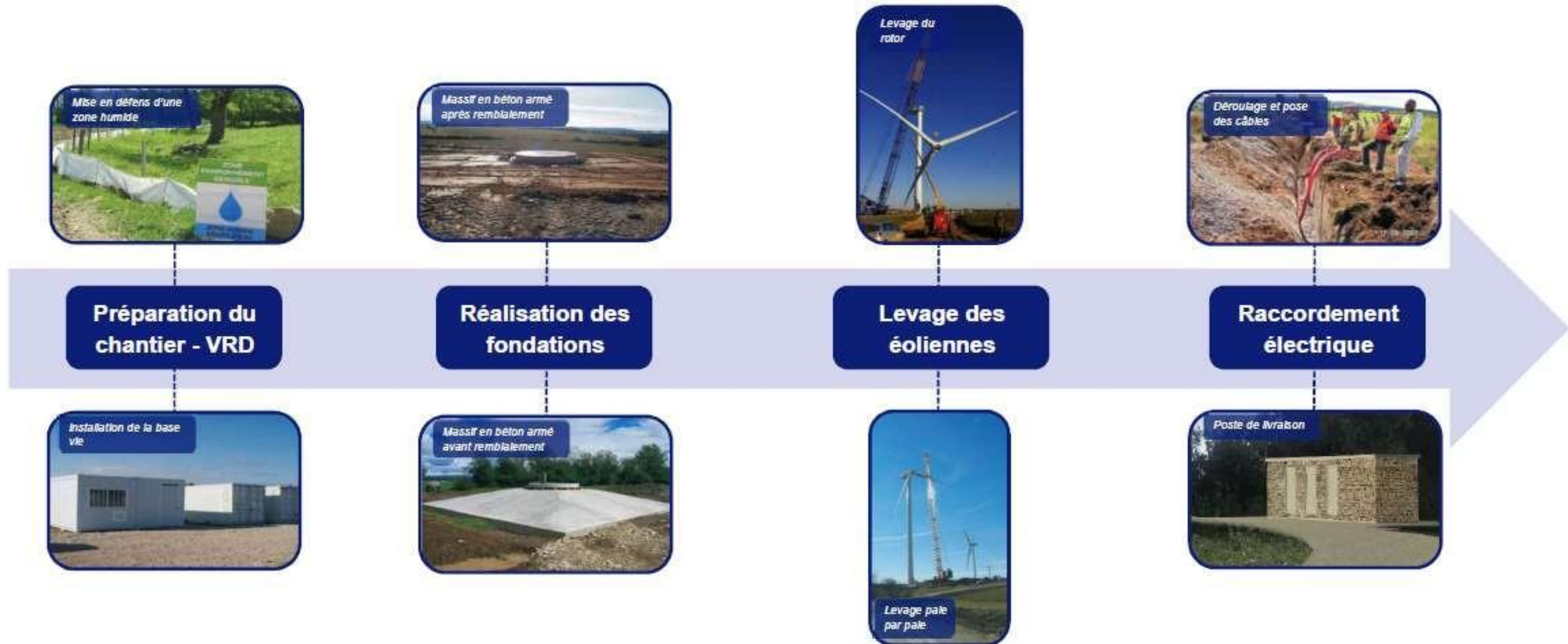
Figure 16 : Phases de travaux de construction d'un parc éolien
