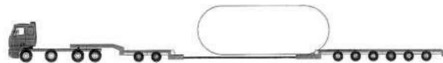
Figure 11 : Transport d'une nacelle
