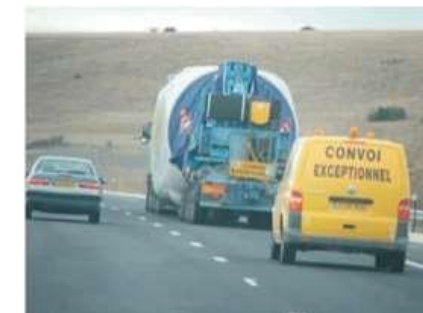
Photographie 8 : Acheminement d'une nacelle par convoi exceptionnel jusqu'au chantier
