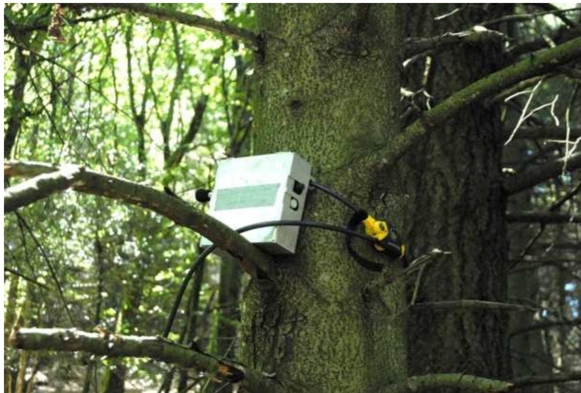
Figure 39 : Pose de SM2Bat+ pour les inventaires acoustiques au sol (Source : J. PELÉ)
