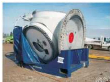
Photographie 2 : Stockage d'un rotor sur une plate-forme Source : EDF Renouvelables
