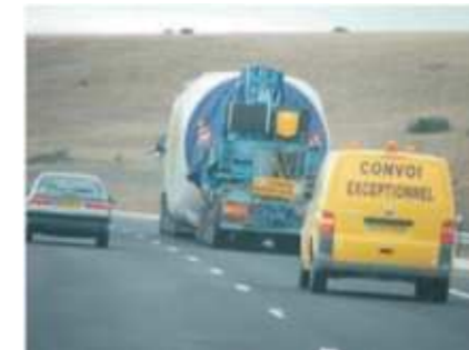
Photographie 8 : Acheminement d'une nacelle par convoi exceptionnel jusqu'au chantier Source : EDF Renouvelables
